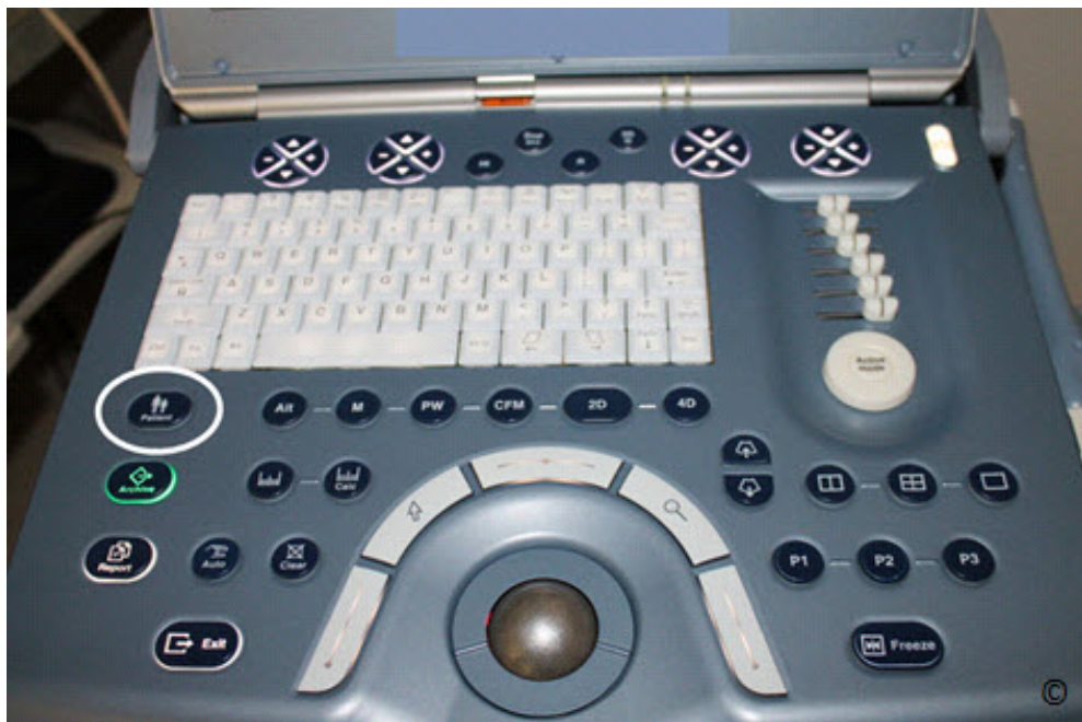
Figura 2.18: Consola de un equipo de ultrasonido que muestra el botón identificado como "Paciente" (círculo blanco), que le llevará a una pantalla donde se introducen los identificadores del paciente antes de iniciar el examen de ultrasonido.
