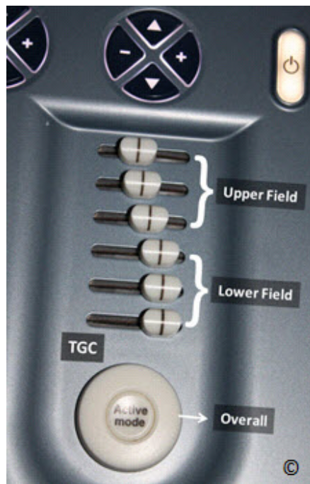
Figura 2.12: Tiempo de compensación de ganancia (TGC) en una consola de ultrasonido. Las perillas superior e inferior ajustan el brillo en los campos superiores e inferiores, respectivamente. El mando general ajusta el brillo en toda la imagen.
